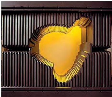
Gezielte Bestrahlung mit präzise verschiebbaren Metall-Lamellen
